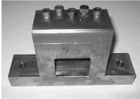
FIG. 13.34 – Structure de test, fréquence propre 304 Hz
